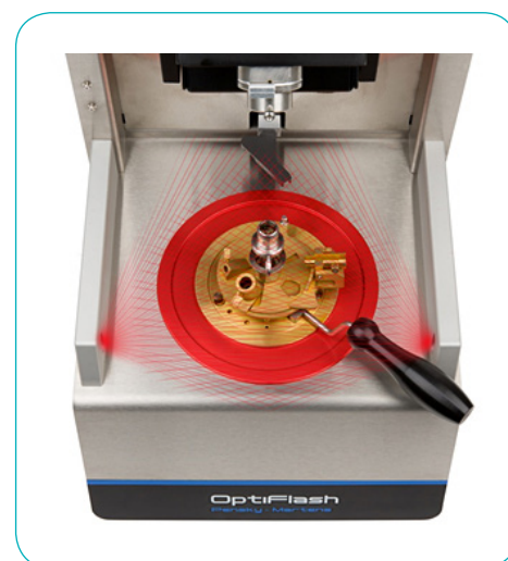
Optyczny system detekcji ognia monitoruje całą gorącą strefę
